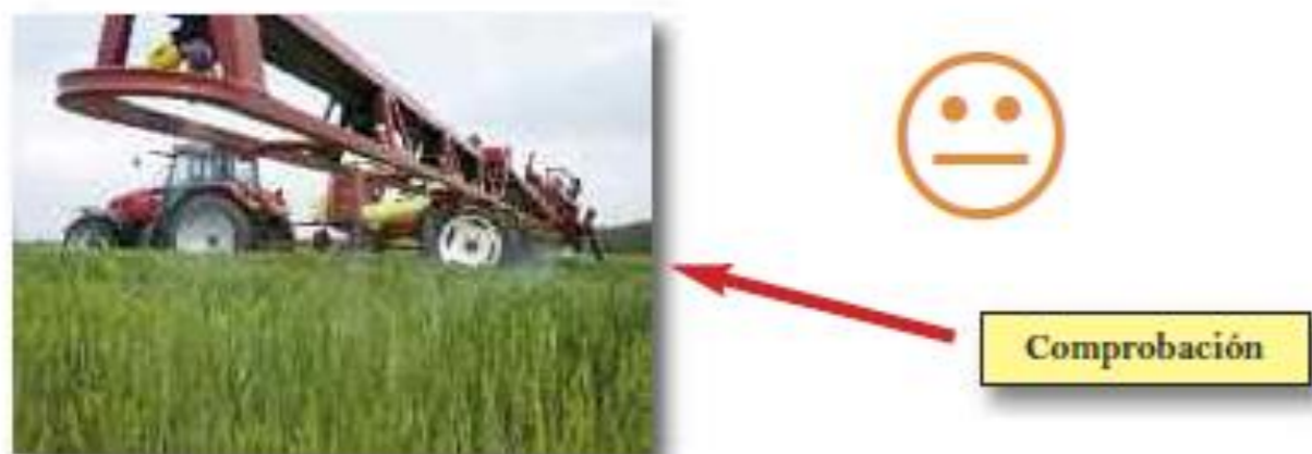
Comprobar la estabilidad de la barra
