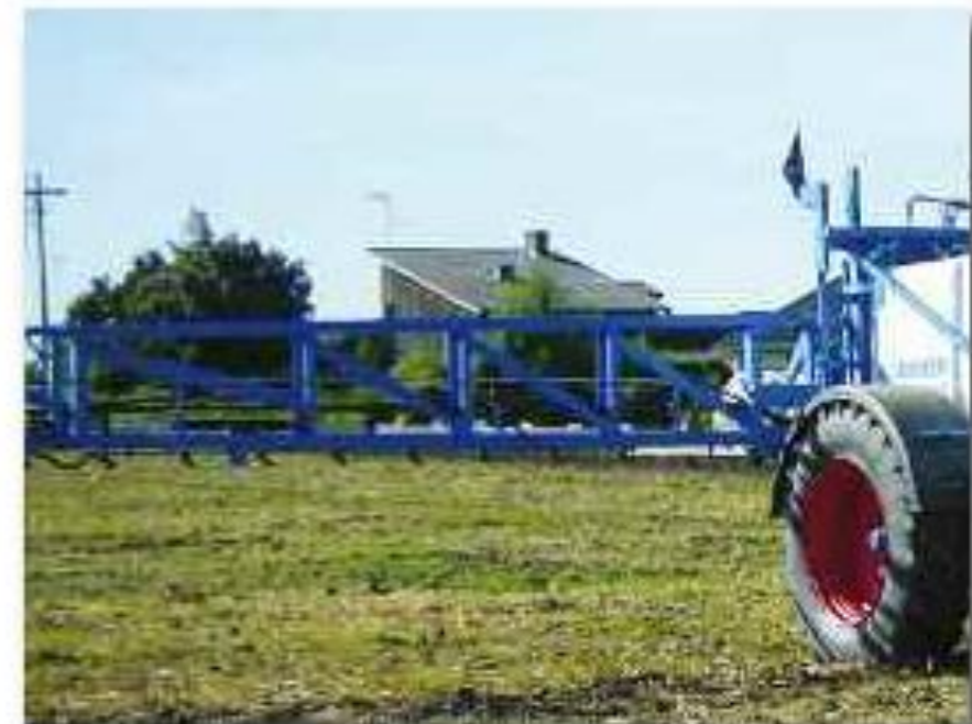
La separación entre boquillas en la barra debe ser constante
