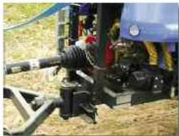
Toma de fuerza, protección y cadena de sujeción correcta
