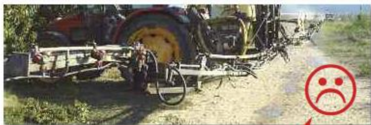
La barra no presenta la estabilidad necesaria. Alguno de los tramos no mantiene su posición
