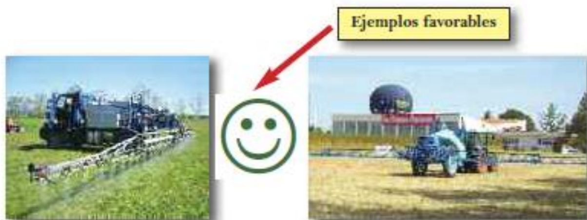
La barra debe mantenerse horizontal y estable
