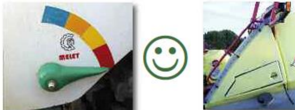
Indicador de nivel correcto y visible desde el punto de conducción y desde el punto de llenado
